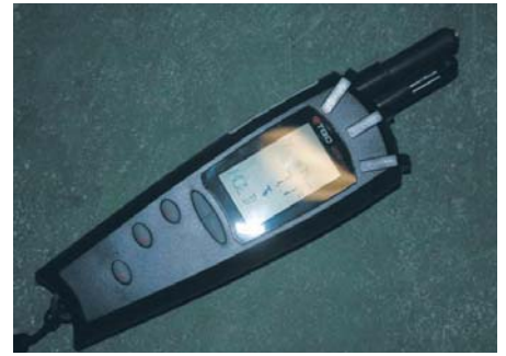
Bei der Applikation von Beschichtungen ist die exakte Erfassung der klimatischen Eckwerte wichtig.
