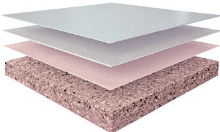
**Mapefloor System 51: Suivant le béton (support) de bas en haut: Mapecoat | 600 W, Mapefloor | 500 W + sable de quartz, Mapecoat | 62 W (coloré).**
