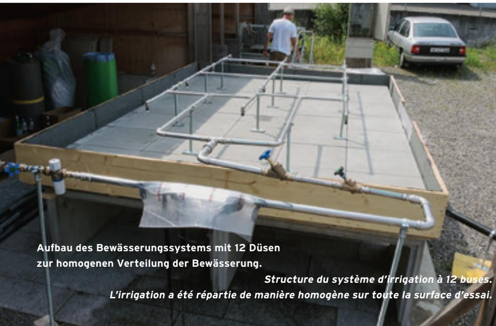
**Aufbau des Bewässerungssystems mit 12 Düsen zur homogenen Verteilung der Bewässerung.**
