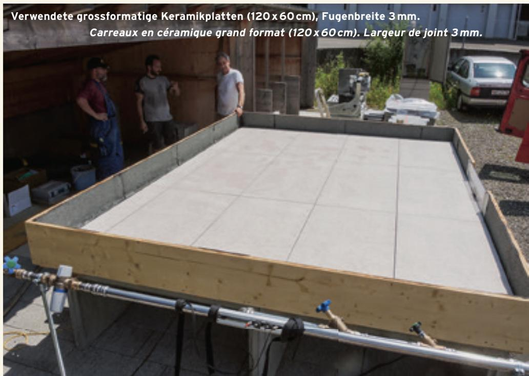
bzw. 30x50 cm (Naturstein) ausgewählt. Grosse Keramikplatten mit einem Format von 120x60 cm wurden ebenfalls getestet. Bei allen Versuchen wurde eine Fugenbreite von 3 mm ausgewählt. Zwischen den Platten und dem Holzrahmen wurde ein Randabstand von 1 cm eingehalten. Das Gefälle der Platten wurde je nach Bettungstyp ausgewählt: 0 % im Fall der Stelzlager und 1.5 % im Fall von Rundkies. Die Bewässerung wurde anhand von 12 Düsen homogen auf der ganzen Testfläche verteilt.
